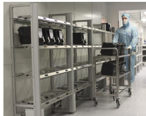
Operator mit RFID Trolley an RFID Regalen
